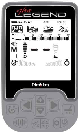
4. Sie können die Empfindlichkeit bei Bedarf erhöhen. Eine Erhöhung der Empfindlichkeit bietet mehr Tiefenleistung. Wenn jedoch die Umgebung oder der Boden übermäßige Signale des Geräts verursachen, sollten Sie die Empfindlichkeitseinstellung verringern.
