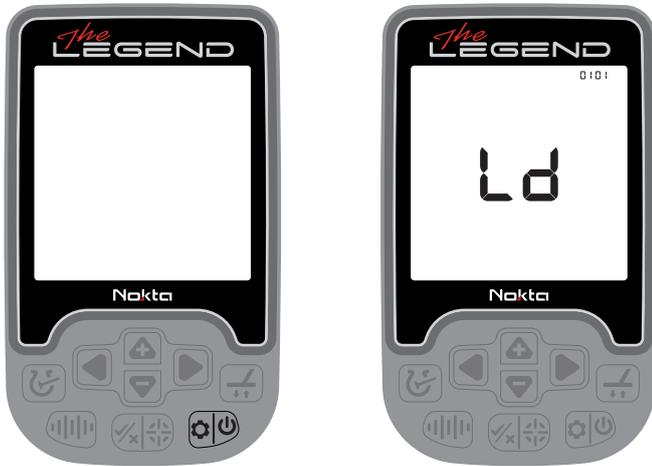
3. Wenn das Gerät eingeschaltet wird, startet es im Parkmodus und im Multifrequenzmodus. Sie können den Modus basierend auf den Bodenbedingungen ändern. Weitere Einzelheiten zu Suchmodi und Frequenzen finden Sie ab Seite 7 in diesem Handbuch.
