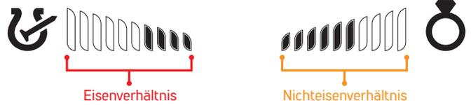
Objekte wie große Eisengegenstände, verrostete Nägel und Flaschenverschlüsse enthalten sowohl Eisen- als auch Nichteisensignale und diese Arten von Objekten können nicht anhand der Leitwerte und des Tonsignals diskriminiert werden. Diese Arten von Objekten können einen Nichteisen-Ton sowie einen Leitwert erzeugen.
